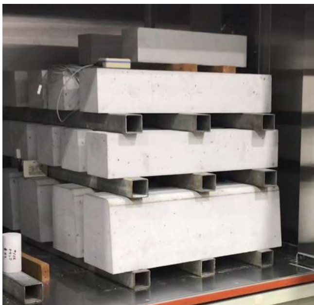
試験製造したCO 2 吸収コンクリート
